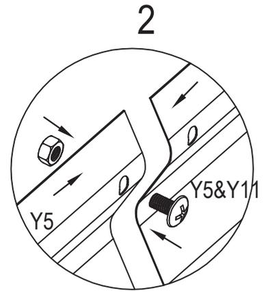
Montieren Sie alle Bleche wie folgt und sichern Sie diese mit den mitgelieferten Schrauben und Muttern.
