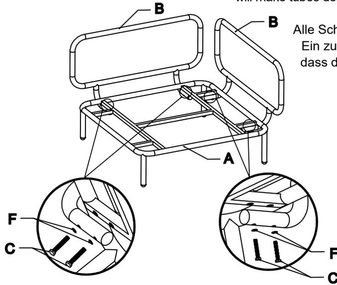
Alle Schrauben anziehen, bis Teil B stabil ist. Ein zu festes Anziehen kann dazu führen, dass die Rohre eingedellt werden.
