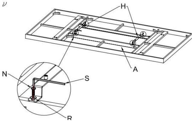
Schrauben lockern und nach vollständiger Montage festziehen
