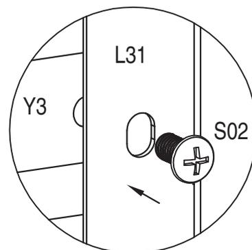
2. montieren Sie die Verlängerungsbleche an die zuvor demontierte Endseite
