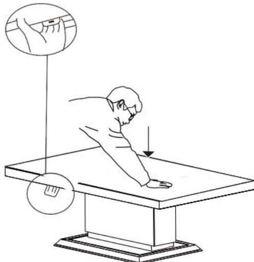
Halten Sie den Hebel und drücken gleichzeitig in der Mitte der Tischplatte nach unten zum Absenken (wie abgebildet).
