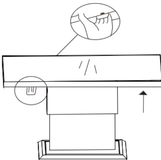
Halten Sie den Hebel zum Erhöhen der Tischplatte bis zur gewünschten Höhe gedrückt.
